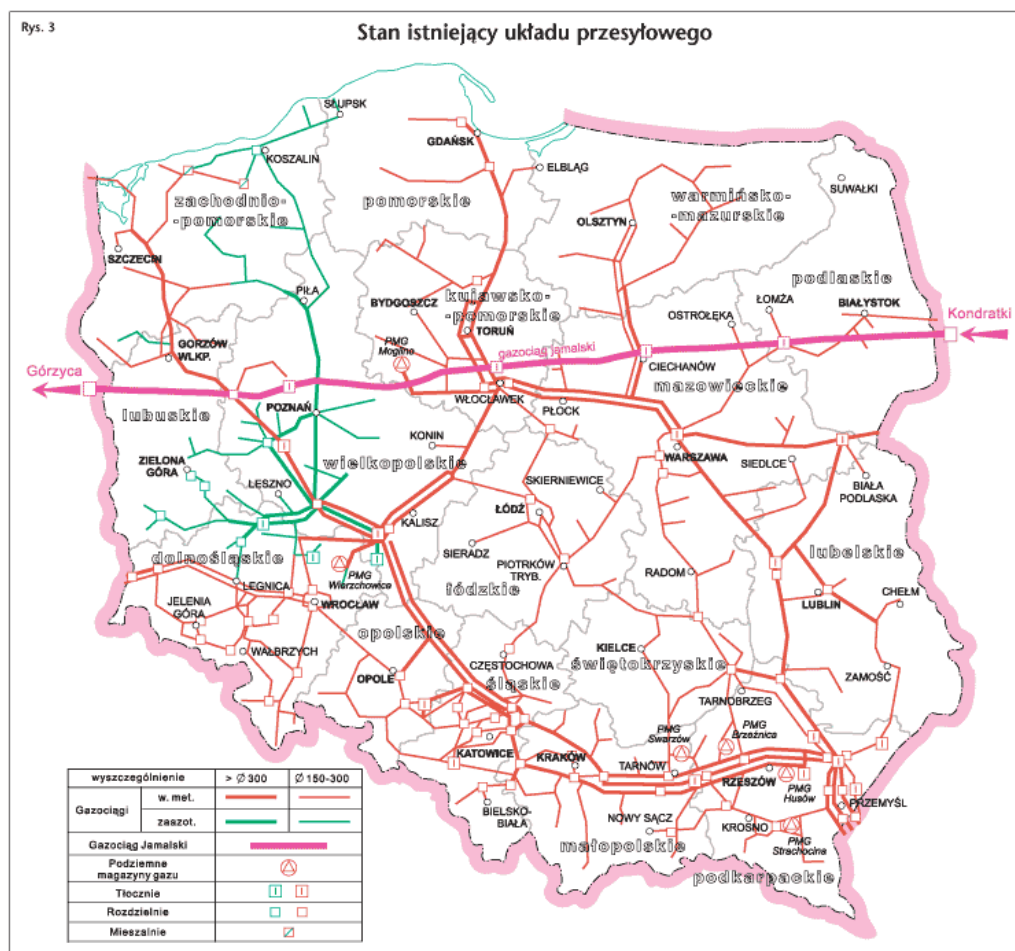
Rys.1 Krajowy system przesyłu gazu ziemnego
